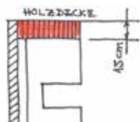
Brennbare Decken (Holzkonstruktion) müssen mit mindestens 15 cm gedämmt werden.
